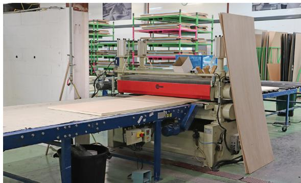
La colle déposée sur le rouleau est transférée sur le panneau, qui est ensuite pressé à chaud. Celui-ci repasse dans la machine après ajout d'autres éléments.
