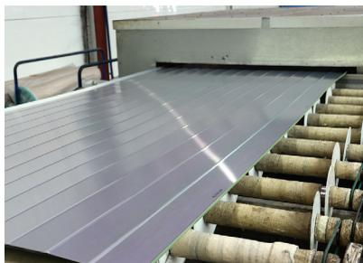
Cette machine forme du grain d'orge et un bord tombé à la tôle pour imiter l'apparence du lattage bois.
