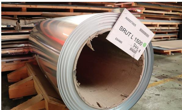
Bobine d'aluminium en stock. Pour la fabrication d'un panneau à volets, deux tôles identiques sont découpées dans la même bobine.
