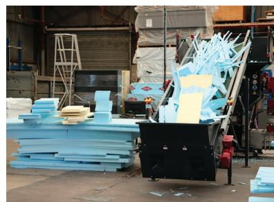
Comme l'alu, l'isolant en polystyrène est recyclé. Broyé et compacté pour limiter son transport, il est retourné au fournisseur pour réintégrer le process de fabrication.
