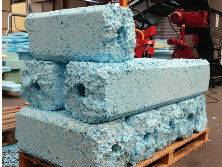
Ces blocs de polystyrène sont recyclés dans le process de fabrication de l'isolant.
