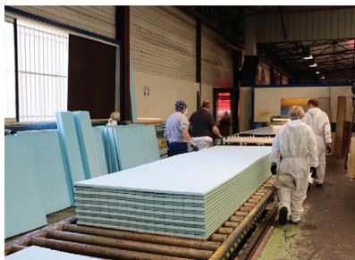
De la colle est pulvérisée sur chaque tôle dans une machine avant l'assemblage des tôles et de l'isolant pour former le panneau.
