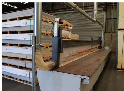
Une première machine découpe le panneau en bandes de 500 mm afin de préparer la séparation des différentes couches.
